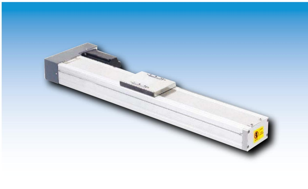
最大行程 800mm      最高速度 1000mm/s      最大负载 30kg      马达容量 400W
